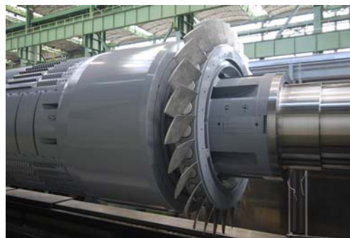
Rys.4. Zmodernizowany wirnik turbogeneratorskiego TWW-320-2Y3
