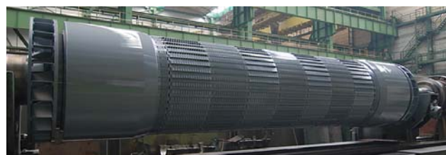
Rys.3. Nowy wirnik turbogeneratorskiego TWW-500-2 wykonany w celu podwyższenia mocy turbogeneratorskiego do 560 MW
