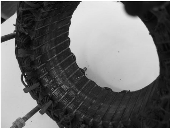
Rys. 8. Skorodowany twornik prądnicy
