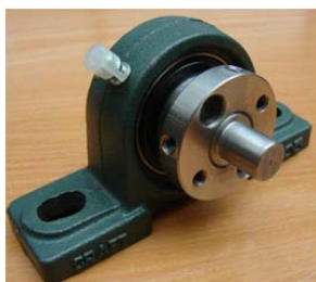
Rys.3. Tuleja z podporą łożyskową do wywołania ekscentryczności
