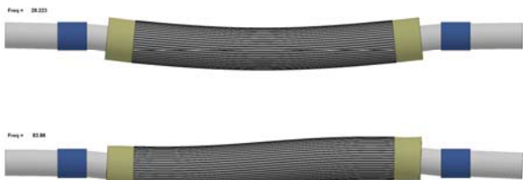
Rys. 5. Postaci drgań własnych wirnika
