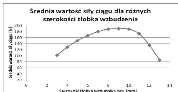
Rys. 7. Średnia wartość siły ciągu dla różnych szerokości żłobka wzбудnika dla blachowanego rdzenia bieźnika
