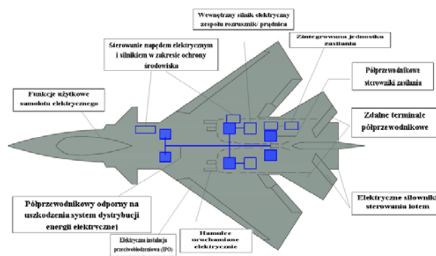
Rys. 4 Przykład współczesnego rozwiązania technologicznego pokładowego autonomicznego systemu zasilania ASE (EPS, PES), zastosowanego na samolocie wojskowym JSF F-35 zgodnie z koncepcją MEA/ AEA [14]
