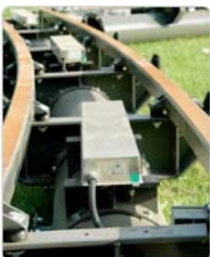
Rys.4. Przykładowe rozwiązanie napędu Vectus, uzwojenie w torze
