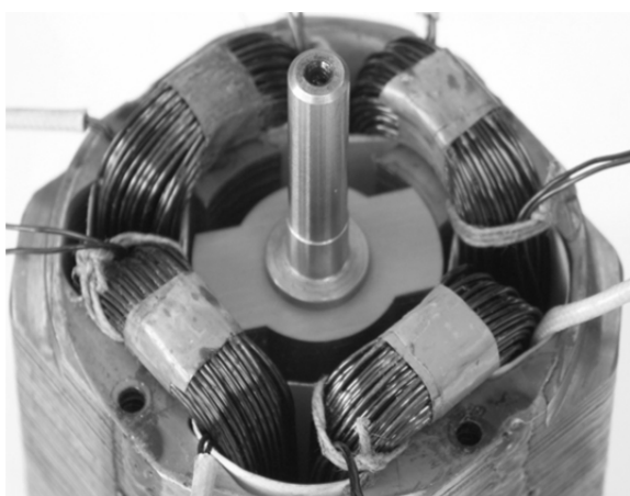
Rys. 1. Widok dwufazowego silnika reluktancyjnego o czterech biegunach stojana i dwóch biegunach wirnika
