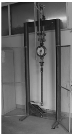
Rys.5. Maszyna wytrzymałościowa przystosowana do wyznaczenia znamionowego obciążenia zginającego SCL
