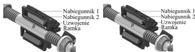
Rys. 2. Powstawanie zmiennego strumienia w przetworniku
