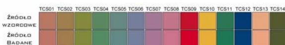
Rysunek 13. Porównanie próbek barwnych oświetlanych źródłem wzorcowym (góra) i źródłem neodymowym (dół)
