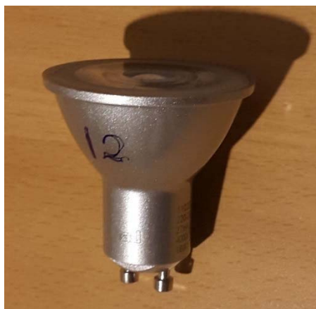
Rys. 3. Kształt lampy LED stanowiącej zamienniki reflektorowej żarówki halogenowej z trzonkiem GU10 (typ PAR16)
