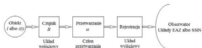
Rys. 6. Tor pomiarowy (ciąg przetwarzania) o strukturze łańcuchowej dla polarymetrycznego czujnika natężenia prądu ze światłowodową cewką pomiarową (Obiekt – przewód fazowy linii elektroenergetycznej, Czujnik – włókno światłowodowe, Przetwarzanie – polarymetr, Rejestracja – komputer klasy PC, Obserwator – osoba wykonująca pomiar, Układy EAZ – Elektroenergetycznej Automatyki Zabezpieczeniowej, Układy SSiN – Systemu sterowania i Nadzoru)
