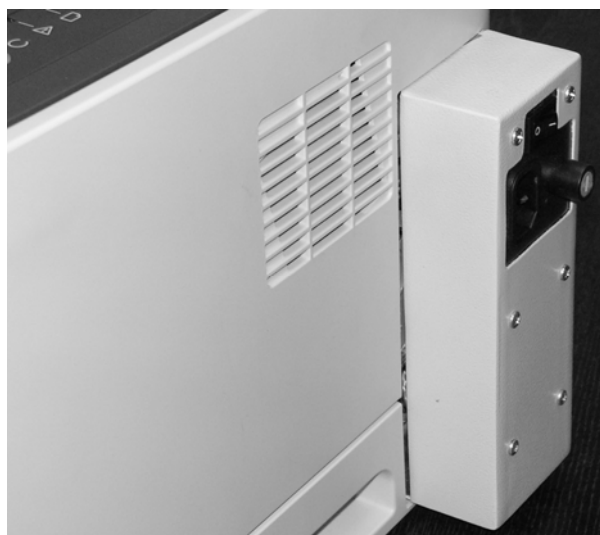
Rys.8. Przykład montażu filtra sieciowego przeciwwzrostającego w urządzeniu drukującym, zapewniającym ochronę elektromagnetyczną drukowanych danych
