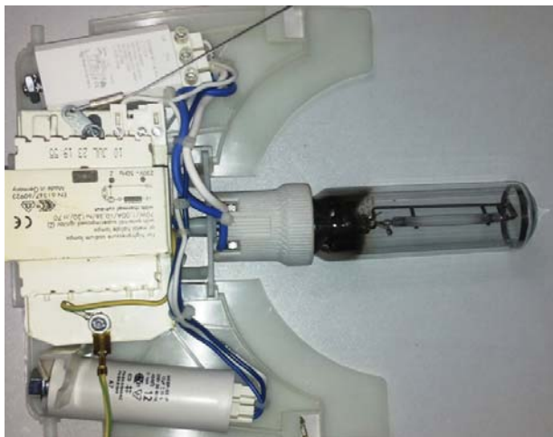
Rys. 16. Lampa sodowa wysokoprężna wraz z układem zapłonowym KVG
