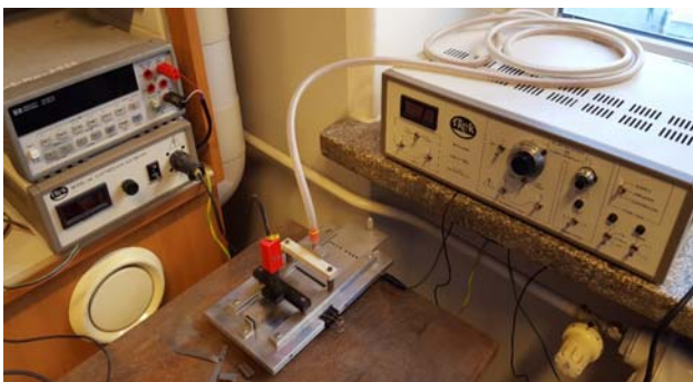
Rys. 1. Zdjęcie układu wykorzystywanego do elektryzacji próbek kompozytowych oraz wyznaczenia czasu półzaniku ładunku elektrycznego
