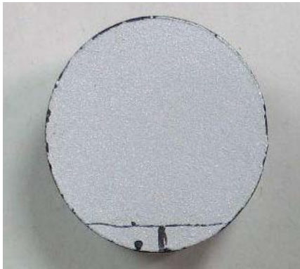
Rys.5 Warystor referencyjny - pochodzący z licznika zadziałań, który nie był w eksploatacji. Na powierzchni czołowej zaznaczono na dole obszar, z którego wycięta została przeznaczona do badań kształtka
