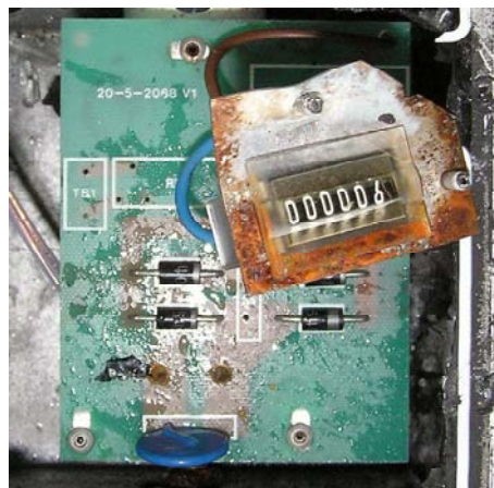
Rys.3 Wnętrze zniszczonego licznika warystorowego
