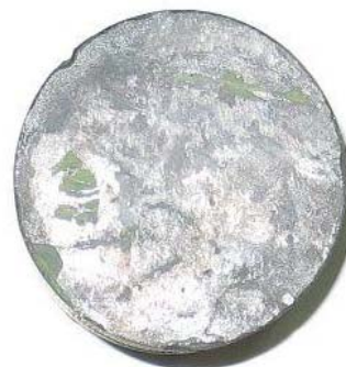
Rys.7 Warystor oznaczony 3, pochodzący ze zniszczonego licznika zadziałań. Zwracają uwagę osady na powierzchni czołowej
