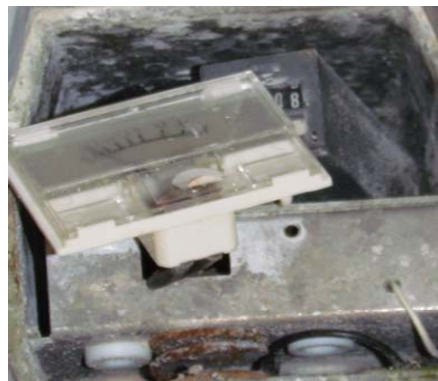
Rys.3 Wnętrze zniszczonego licznika warystorowego
