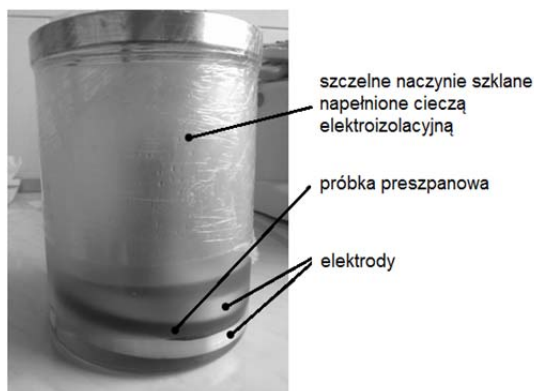
Rys.3. Naczynie z umieszczonymi w nim elektrodami i próbkami preszpanowymi
