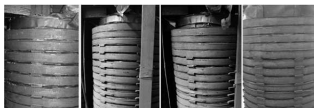
Rys.3. Symulowana deformacja uzwojenia – ścisnięcie cewek
