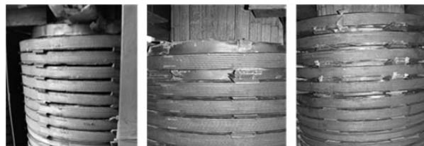
Rys.2. Symulowana deformacja uzwojenia – rozsuwanie cewek
