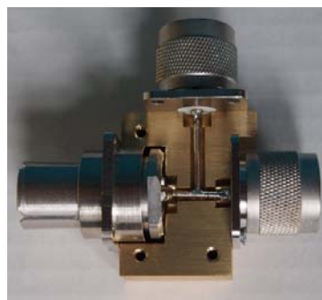
Rys. 6. Trójnik opracowany w KMEiA, wykorzystany do połączenia należącego do GUM wzorca z systemem pomiarowym KMEiA. Trójnik jest wyposażony w dwa złącza N oraz złącze GR-874
