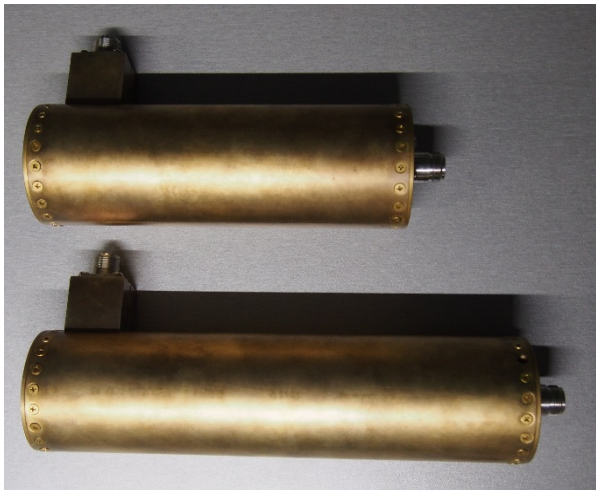
Rys. 2. Wzorce 3 V oraz 5 V o licznej różnicy transferowej opracowane, zbudowane i utrzymywane w KMEiA
