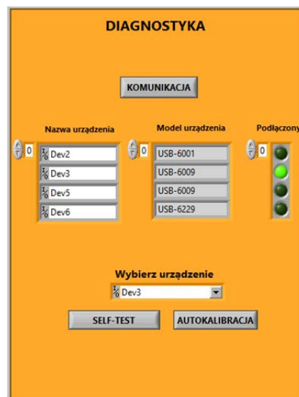
Rys.3. Zakładka modułu „DIAGNOSTYKA” wskazująca na podłączenie do komputera karty NI USB-6009 jako „Dev3”
