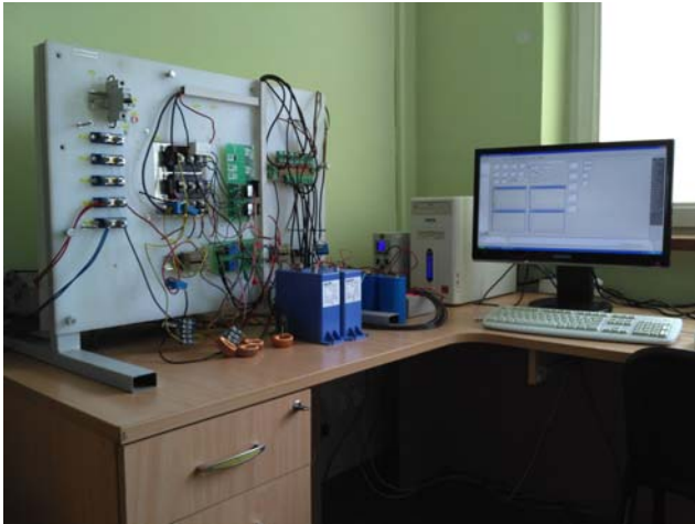
Fot.1. Stanowisko laboratoryjne z przetwornicą DC-DC obniżającą napięcie i kartą dSpace
