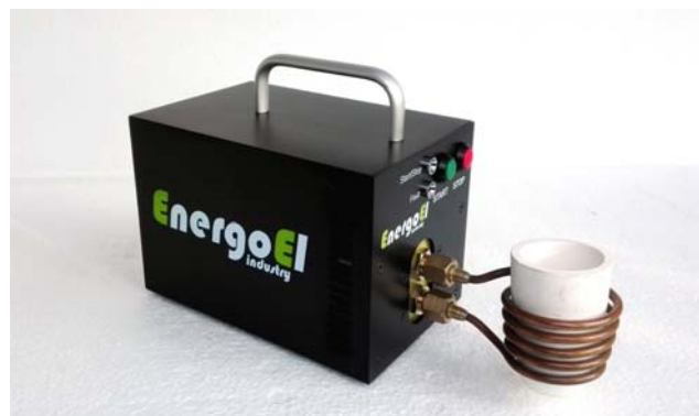
Rys.7. Piec indukcyjny wysokiej częstotliwości do przetopu proszków
