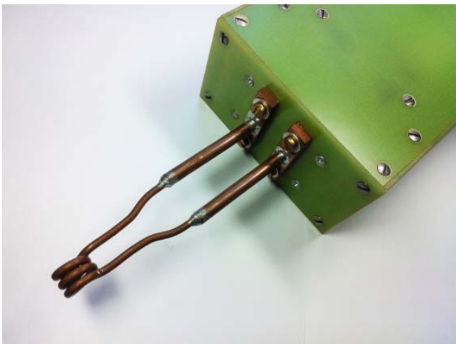
Rys. 9. Widok wzbudnika nagrzewnicy z transformatorem
