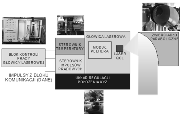
Rys. 5. Schemat blokowy toru nadawczego FSO
