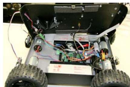
Rys. 1. Widok kołowej platformy mobilnej z podniesioną pokrywą
