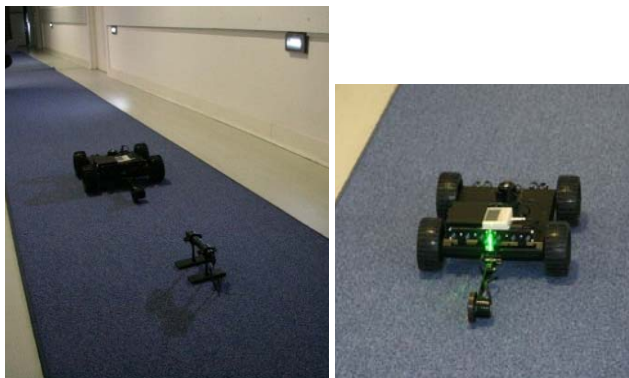
Rys. 6. Widok modelu urządzenia pomiarowego podczas wykonywania pomiarów natężenia oświetlenia ewakuacyjnego na korytarzu
