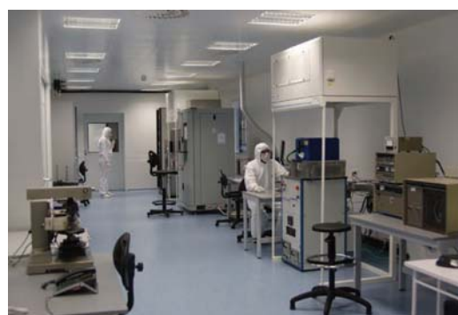
Rys.10. Reaktor epitaksyjny MBE, Riber Compact 21T oraz clean-room klasy 100, specjalizujący się w procesingu struktur półprzewodnikowych związków A III B V
