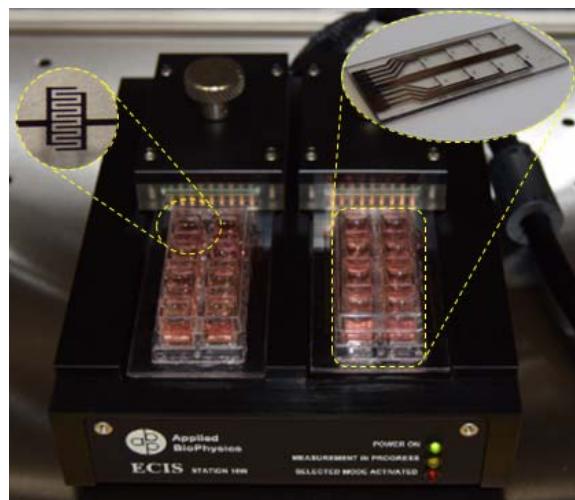
Rys.2. Zestaw elektrod umieszczonych w uchwycie systemu ECIS®
