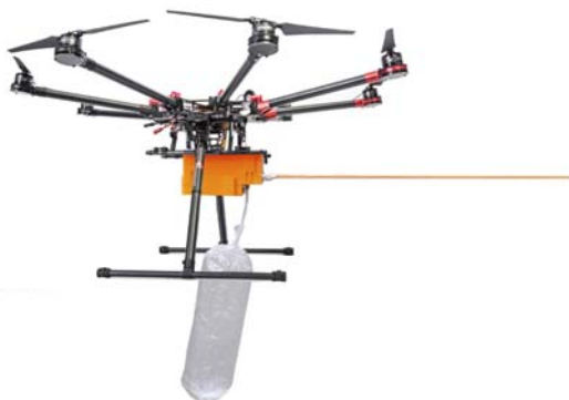
Rys. 7. Dron z podwieszoną aparaturą kontrolno-pomiarową do poboru i analizy próbek powietrza
