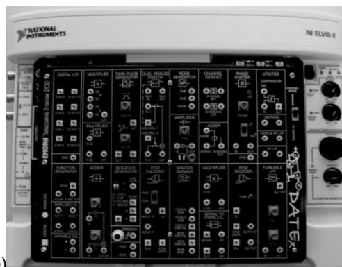
Rys.1. Zestaw NI ELVIS II z nakładką uniwersalną a) oraz nakładką Emona DATEx b)
