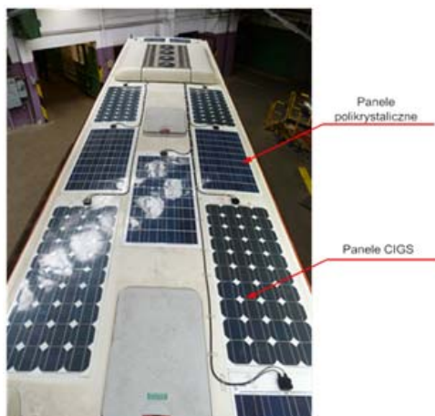
Rys. 1. Panele fotowoltaiczne zamontowane na dachu autobusu
