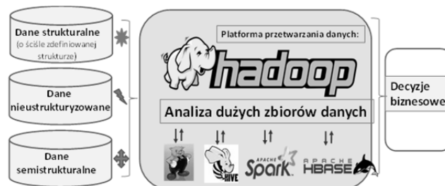
Rys.1. Platforma przetwarzania dużych zbiorów danych: strukturalnych, nieustrukturyzowanych oraz semistrukturalnych.
