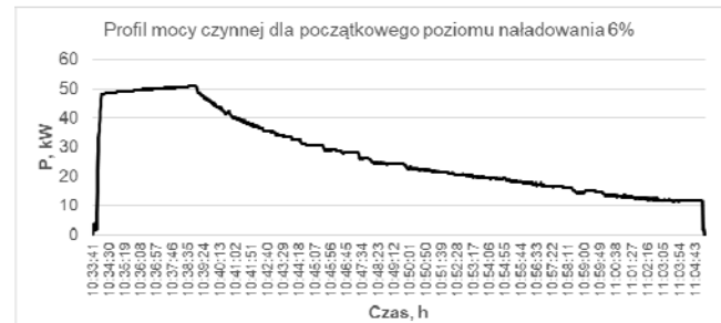
Rys.6. Przebieg poboru mocy po stronie AC podczas ładowania pojazdu elektrycznego dla początkowego poziomu naładowania akumulatorów 6% [opracowanie własne]
