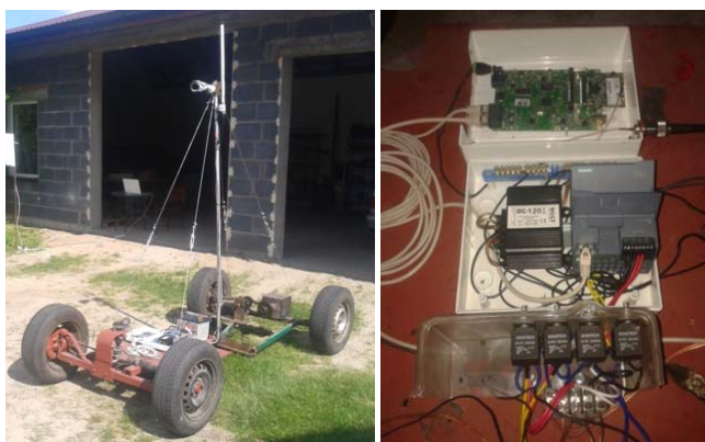
Rys. 2. Prototyp elektrycznego pojazdu autonomicznego wraz z systemami: wizyjnym, sterowania i komunikacji bezprzewodowej
