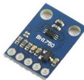
Rys. 1. Widok czujników natężenia oświetlenia typu TEMT6000 (a) i BH1750FVI (b) [1, 2]
