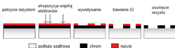
Rys. 2. Schemat procesu wytwarzania masek do fotolitografii
