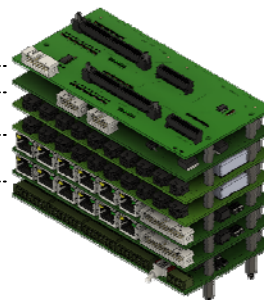
Rys. 6. Wizualizacja 3D projektu elektronicznej platformy sterującej
