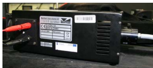
Rys. 4. Widok kwarcowego-halogenowego źródła wzorcowego CL 6 oraz zasilacza prądu stałego typ 605
