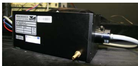
Rys. 3. Widok deuterowego źródła wzorcowego CL 7 oraz zasilacza typ 706
