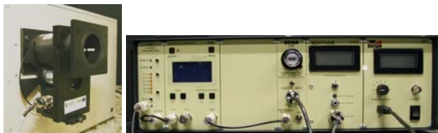
Rys. 6. Kompletny przekąźnikowy element optyczny z łopatką zamontowany do wejścia monochromatora oraz zasilacz typ 417
