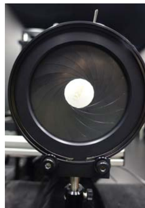
Rys. 11. Widok przesłony irysowej usytuowanej tuż przed badanym źródłem
