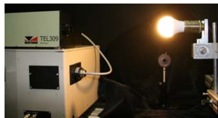
Rys. 2. Widok teleskopu TEL 309 podłączonego do monochromatora podczas pomiarów luminancji energetycznej
