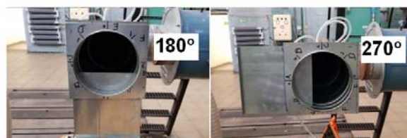
Rys. 2 . Pozyce przesłony – kąt obrotu: a) 0°, b) 90°, c) 180°, d) 270°
