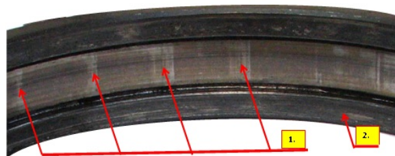
Rys. 2. Widok bieżni zewnętrznej (wycinek) łożyska szybkoobrotowego po długotrwałej współpracy w stanie rezonansu, gdzie: 1. – fałszywe odciski Brinella, 2. – pierścienie (zewnętrzny) łożyska środkowej podpory wału głównego silnika turbodoprzutowego.
