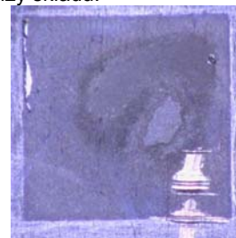
Rys. 2. Powierzchnia ścinania na podłożu DBC z (2 μm)Sn po ścięciu chipu HEMT z metalizacją Ag (naprężenie 11,8 MPa).
