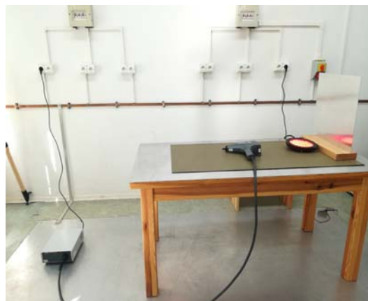
Rys. 5. Stanowisko do badań odporności na wyładowania elektrostatyczne (ESD)
