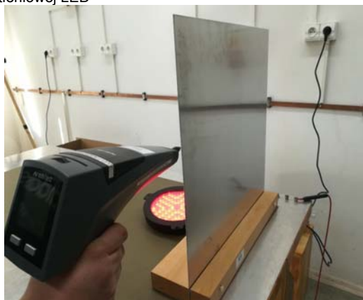
Rys. 3 Wyładowanie kontaktowe przykładane do płaszczyzny sprzęgającej VCP
