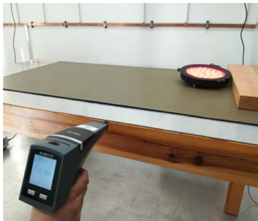
Rys. 4 Wyładowanie kontaktowe przykładane do płaszczyzny sprzęgającej HCP
