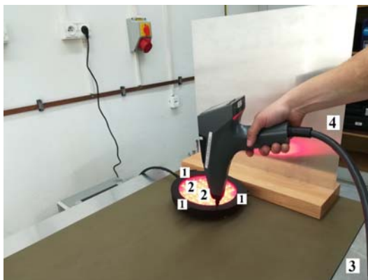
Rys.2. Narażane punkty podczas wyładowań ESD lampy oświetleniowej LED
