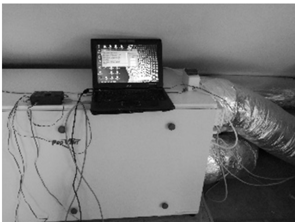
Rys.2. System pomiarowy w trakcie rejestracji parametrów roboczych rekuperatora
