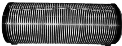
Rys. 4. Fotografia cewki z rezystorami bocznikującymi sekcje uzwojeń
