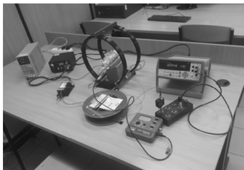
Rys. 5. Stanowisko laboratoryjne do pomiaru charakterystyki przetwarzania
