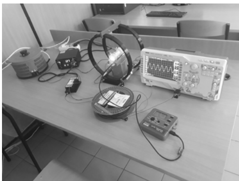
Rys. 3. Stanowisko do rejestracji odpowiedzi detektora na wymuszenie sinusoidalne
