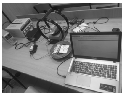
Rys. 7. Stanowisko laboratoryjne do pomiaru charakterystyki kierunkowości
