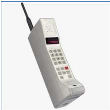
Rys. 4 Terminal w technologii 1G [15]
