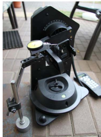
Rys.2. Stanowisko do pomiaru powtarzalności ustawień napędu [8]
