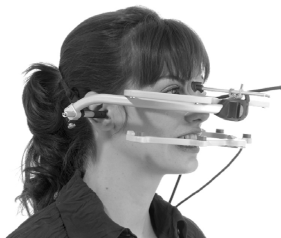
Rys.9. Rejestracja ruchów żuchwy za pomocą Arcus Digma [6]
