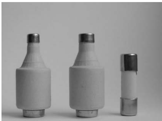
Rys.10. Korpusy wkładek zastosowane do badań topików: (od lewej) wkładki typu DII na prąd znamionowy 10A i 16A oraz wkładka typu 10×38
