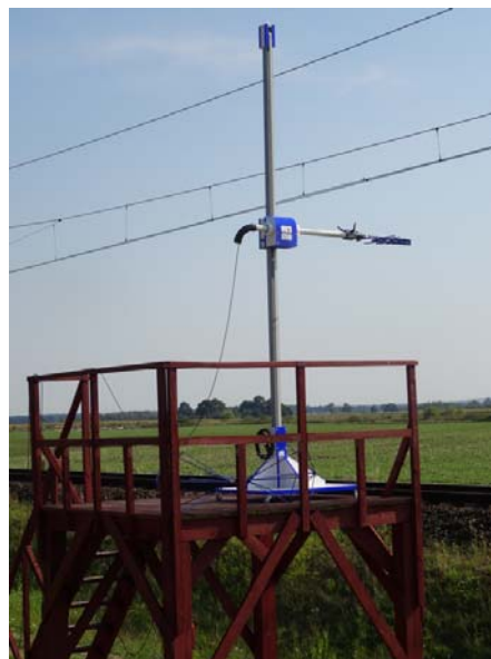
Rys. 4. Stanowisko do badań EMC na Okręgu Doświadczalnym
