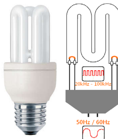
Rys.2. Świetlówka kompaktowa i jej schemat uproszczony.
